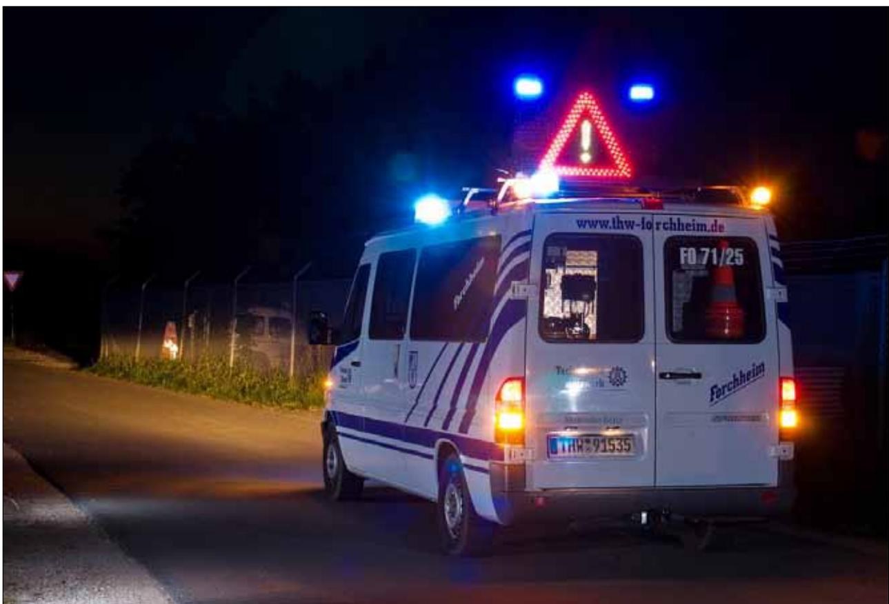
**Mehr Sicherheit beim Autobahnbereitschaftsdienst** leistet das neue Heckwarnsystem des THW Forchheim, das mit der Unterstützung der HeVe angeschafft wurde. Zur Stauabsicherung können mittels Hochleistungs-LEDs Laufpfeile, die Wörter „Unfall“ und „Stau“ sowie ein Warndreieck eingeblendet werden.
